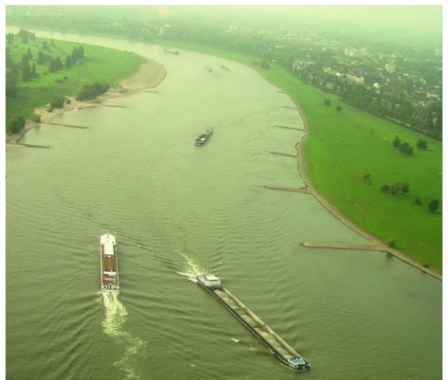
Abbildung 13: Schematische Darstellung von Flussbuhnen und der entstehenden Wirbelströmung (links); Buhnen im Rhein (rechts)
